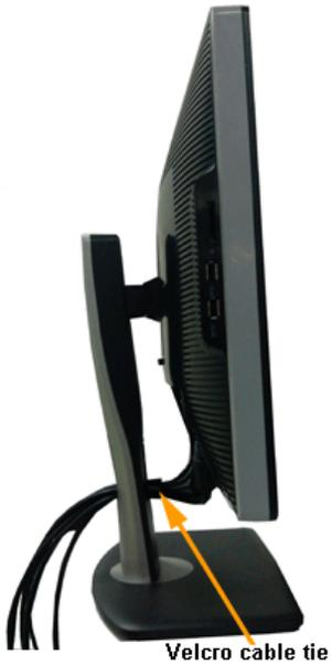
Setelah memasang semua kabel yang diperlukan ke monitor dan komputer, (Lihat [Menyambungkan Monitor](#) untuk pemasangan kabel,) gunakan slot manajemen kabel untuk mengatur semua kabel seperti ditunjukkan di bawah ini.
